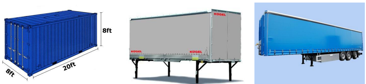
Abbildung 6: links: 20-Fuß-ISO-Container 85 ; mitte: Wechselbrücke 86 ; rechts: Sattelaufleger 87
